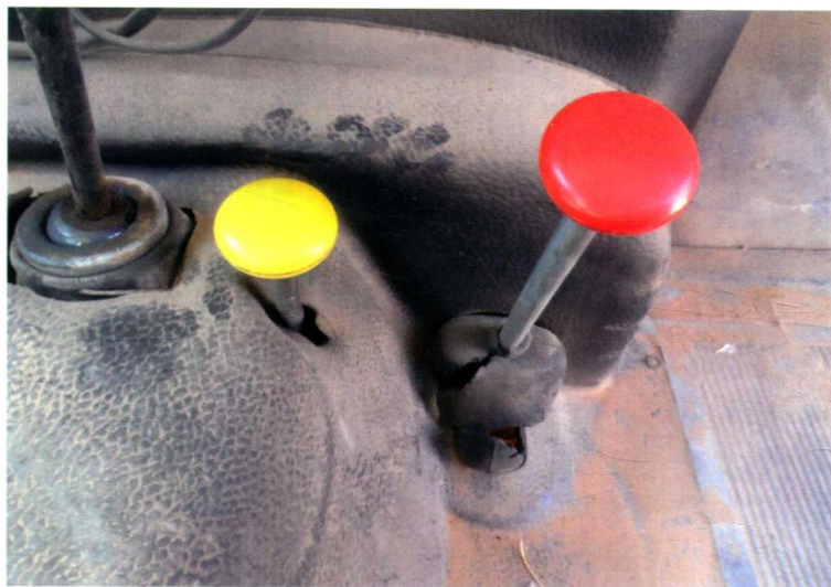
上图：路虎 I、II、IIA 和 III 系列的“高速”“低速”和“四轮驱动”挡位选择杆
