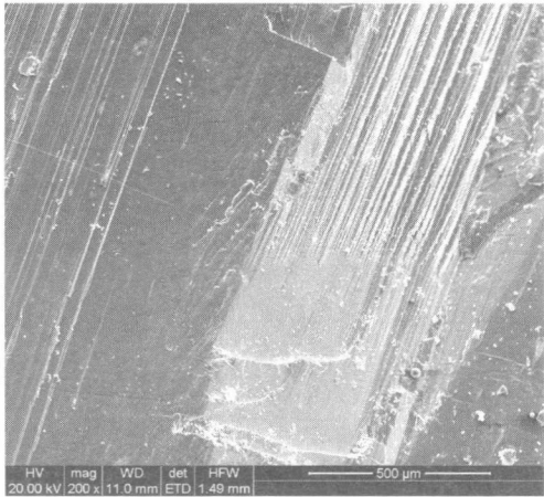
图 1-12 大结晶电熔镁砂的断口形貌
