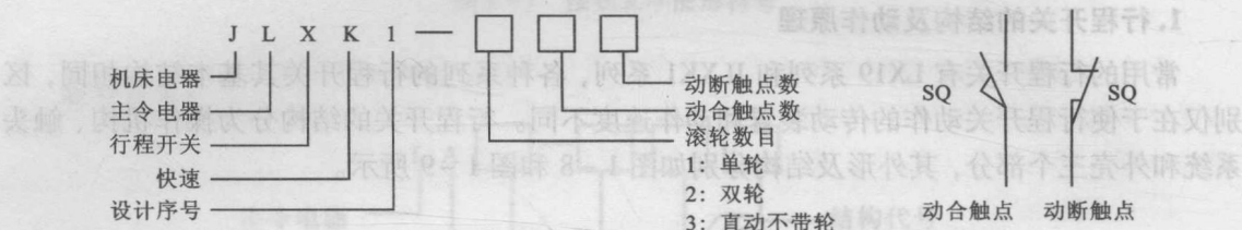
图 1-10 行程开关型号含义与文字图形符号
