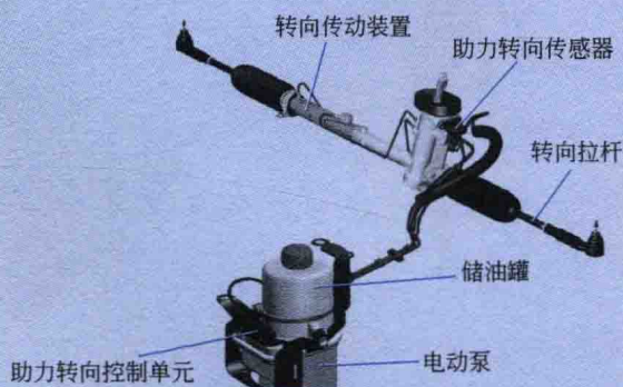
图 1-11 电子液压随速可变助力转向系统
