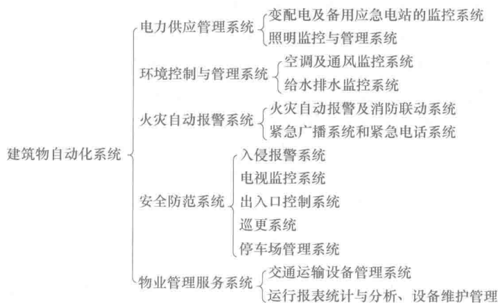
图 1-2 建筑物自动化系统的构成
