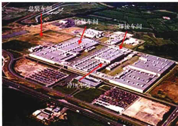
图 2-1 汽车制造工厂 (总装车间、涂装车间、焊接车间、冲压车间)
