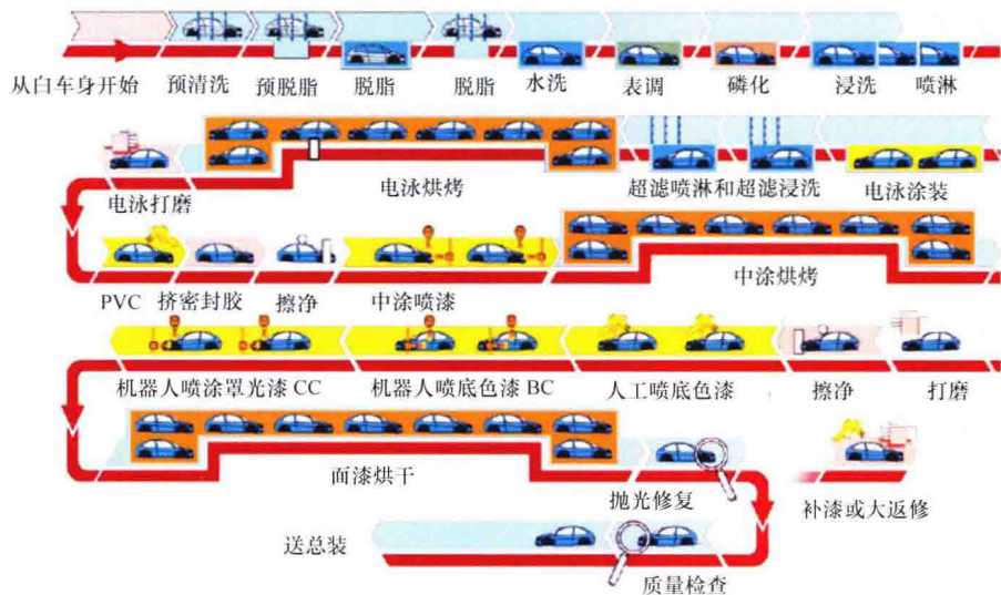
图 2-2 汽车涂装车间工艺流程
