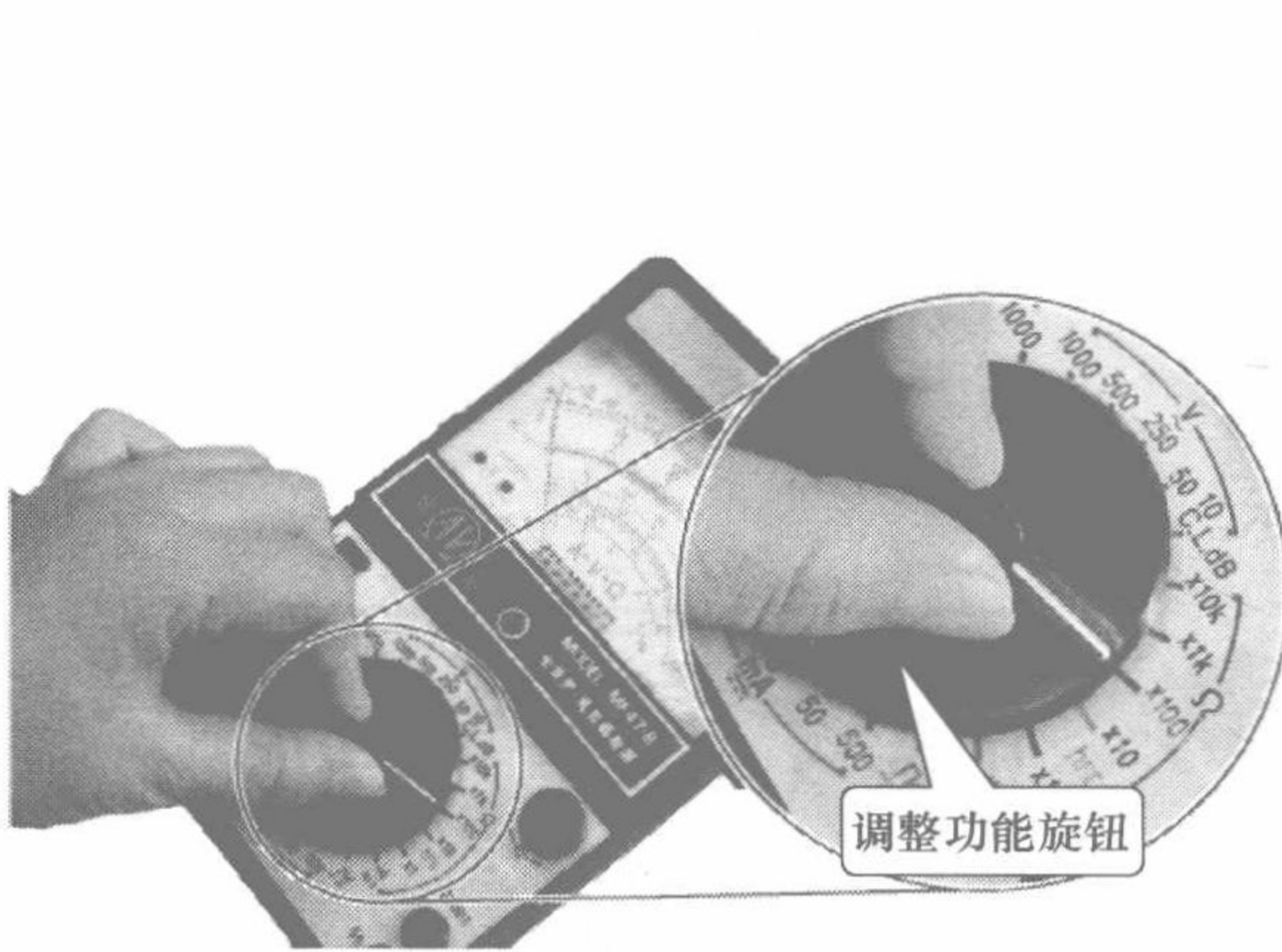
图 1-2 调整万用表的功能旋钮
