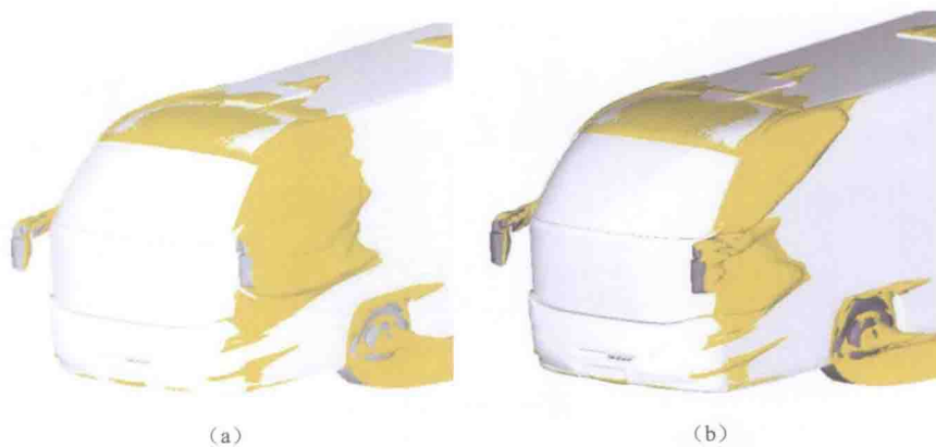
图 2-46 带有传统后视镜和整体式后视镜的 Neoplan Cityliner 上的气流分离(各向同性面 pt=0 ) (a) 传统后视镜; (b) 整体式后视镜
