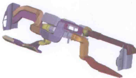
图 2-67 脚部空间通风和侧窗通风用 空气管道的复杂性
