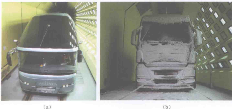
图 2-66 气候风洞中的 Neoplan Starliner 和 TGV (a) Starliner; (b) TGV
