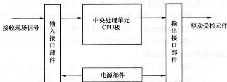
图 1-7 PLC 内部结构示意图
