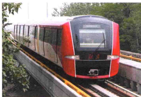
图 0-10 爬坡能力更强的 QKZ5 型直线电机车
