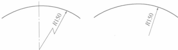
图 1-28 大圆弧半径的标注方法
