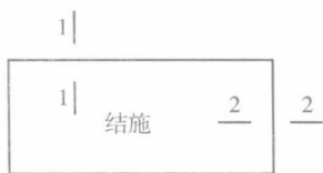
图 1-2 断面剖切符号
