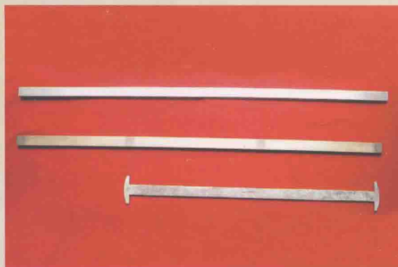
图 03: 广州市人民政府工商局度量衡检定所在 1951 年接收了民国时期保存下来的度器: 从上到下为 1 米铜直尺两把, 三等精度; 2 市尺铜量端器一把, 均为 1930 年制造。
