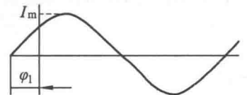
图 1.14 正弦电流的波形图
