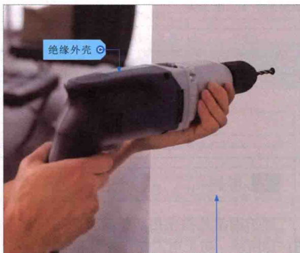
电工操作中的大多数工具、设备等采用绝缘材料制成外壳或手柄，实现与内部带电部分的电气隔离
