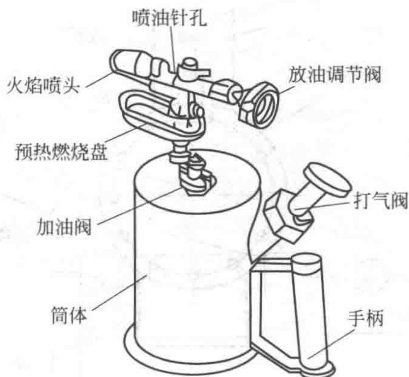
图 1-11 喷灯的结构
