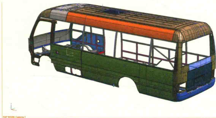
图 1-3 钣金和骨架复合式车身
