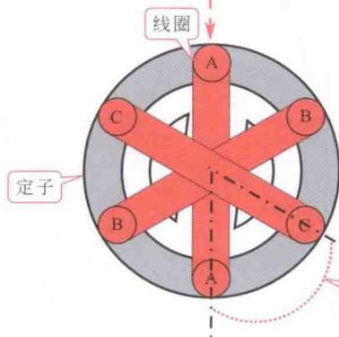
三相交流电是由三相交流发电机产生的。在定子槽内放置着三个结构相同的定子绕组A、B、C，这些绕组在空间互隔 $120^\circ$ 。转子旋转时，其磁场在空间按正弦规律变化，当转子由水轮机或汽轮机带动以角速度 $\omega$ 等速地顺时针方向旋转时，在三个定子绕组中，就产生频率相同、幅值相等、相位上互差 $120^\circ$ 的三个正弦电动势，这样就形成了对称三相电动势
