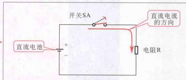
2 由直流电供电的电路称为直流电路，该电路是指电流流向恒定不变的电路，它是最基本的电路
