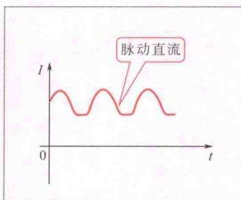
1.1 直流电可以分为脉动直流和恒定直流两种，脉动直流中直流电流大小是跳动的；而恒定直流的电流大小能够是恒定不变的
