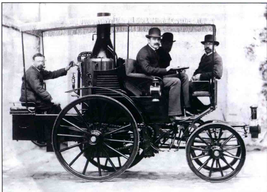
一辆1884年制造的“面对面”乘坐的蒸汽汽车，后面那位是负责烧锅炉的“副驾驶”
