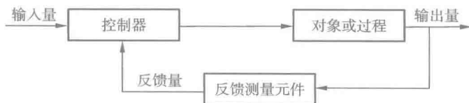
图 1-8 闭环控制系统方框图
