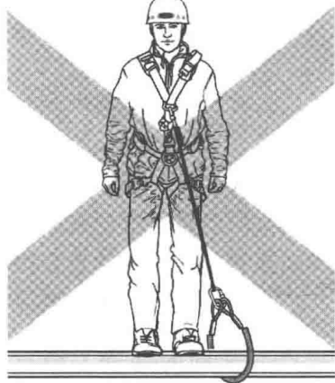
图 1-2 挂点升高增加潜在下坠距离
