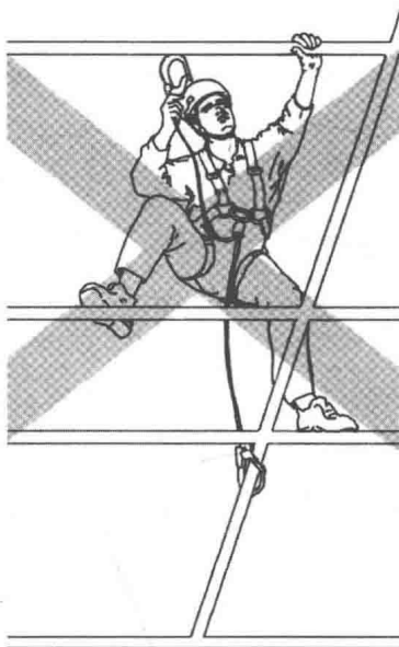
图 1-3 系缚点可以向下滑动增加潜在下坠距离
