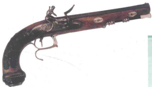
法国前装线膛燧发手枪 (1800 年左右生产，八棱 枪管，口径 13.7mm，全长 360mm)
