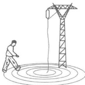
图 1-4 跨步电压触电
