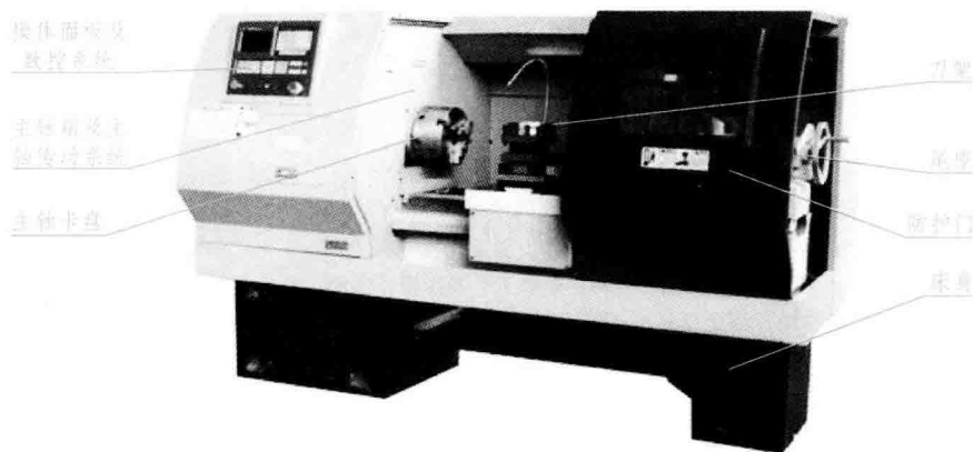
图 1-6 卧式数控车床部分组成结构
