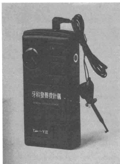
图 15.黄力子等发明的牙科发声探针仪可代替 X 照片，测量根管长度，确定龋洞是否穿髓。已正式生产，产品获 1987 年国家发明三等奖。
