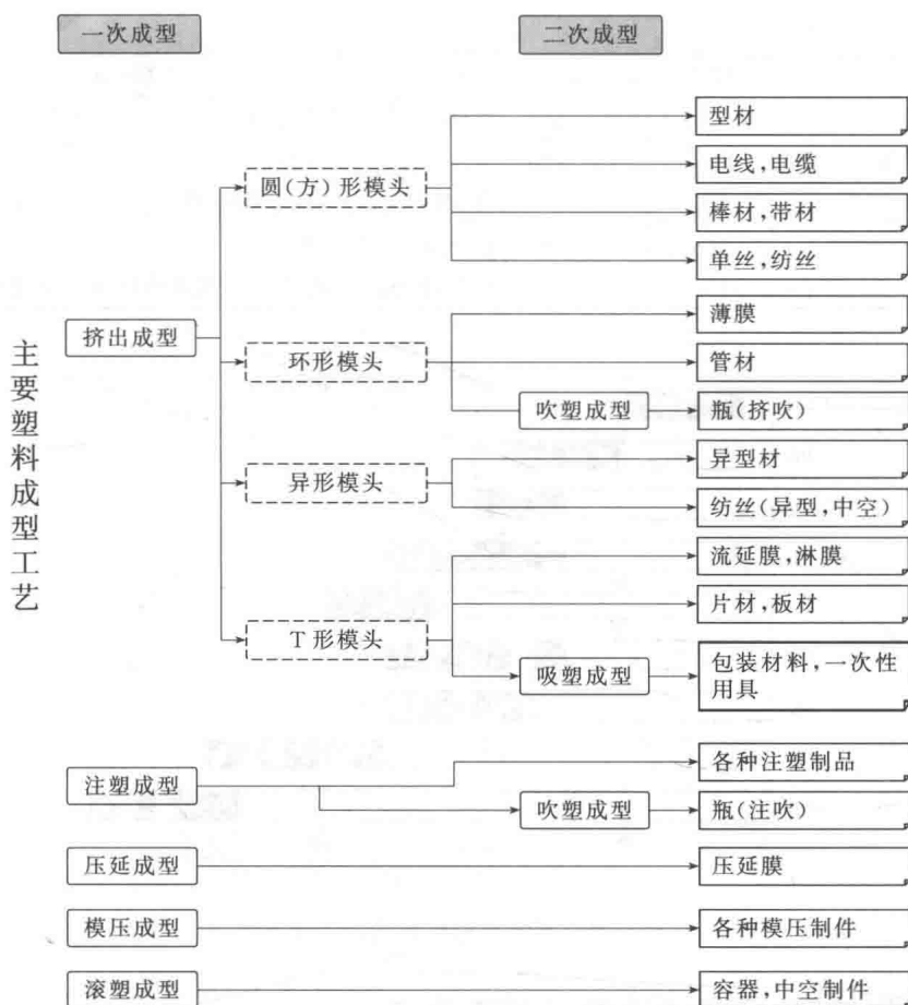
图 1-3 塑料成型及产品示意图
