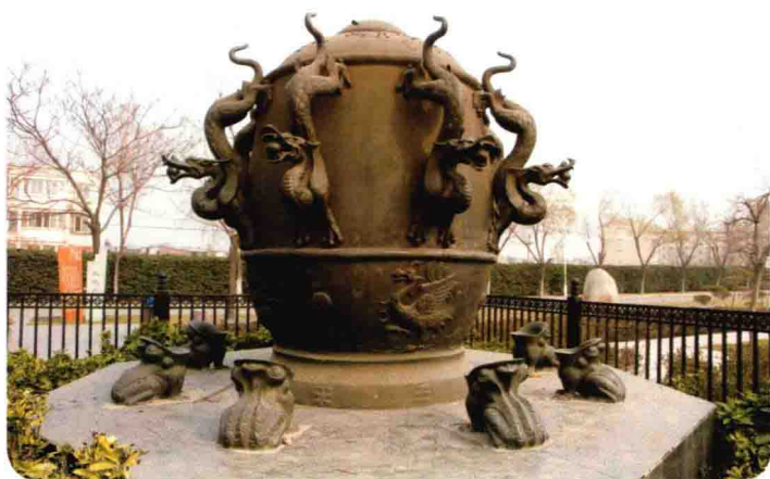
张衡发明的候风地动仪的复原模型
