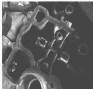
图 1-4 高压油泵堵盖丢失
