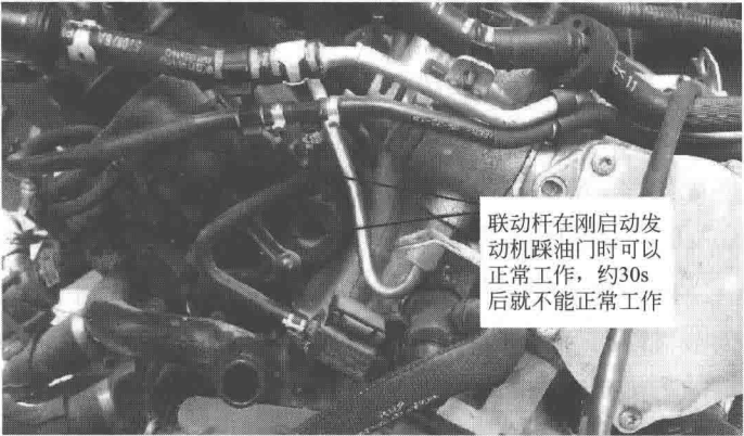
图 1-9 风门切换真空单元工作情况
