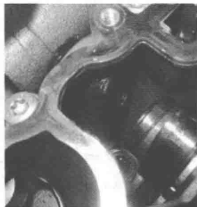
图 1-4 高压油泵堵盖丢失
