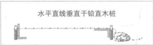
图 7. 水平的刻度绳在两根高度相等的铅直木桩间绷紧。
