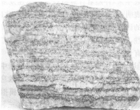
图 2 变质岩的片状构造
