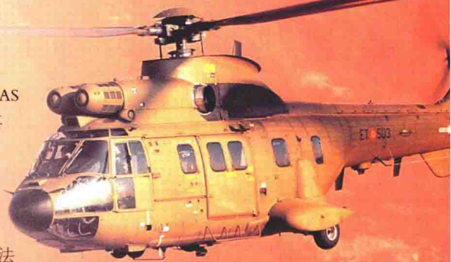
上图: AS 532UC保留了原来的“美洲豹”机舱容量。然而, 在主旋翼轴线下方的舱底开口可以用来吊挂运输多达9920磅(4500千克)的货物
