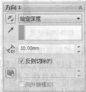
图 1-26 拉伸切除设置界面
