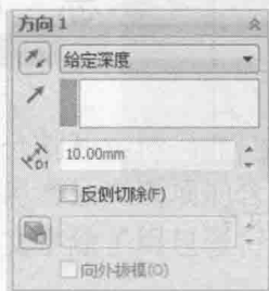
图 1-34 拉伸切除设置界面
