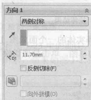
图 1-38 拉伸切除设置界面
