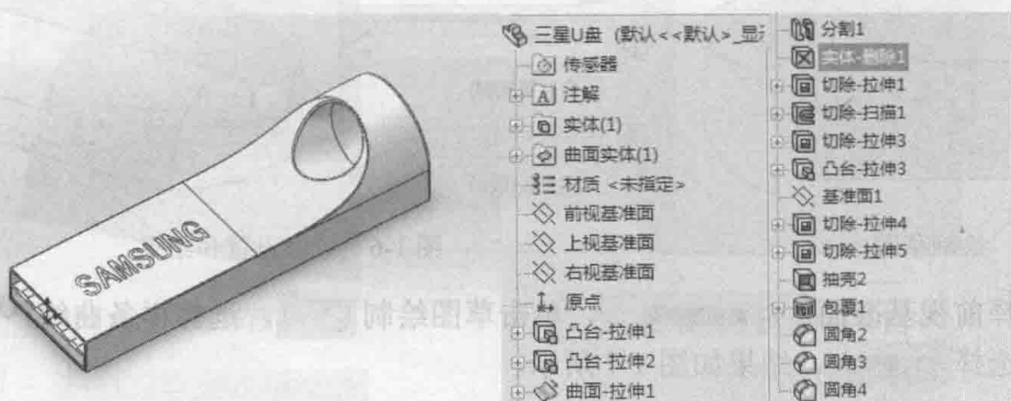
图 1-1 U 盘实体模型和设计树
