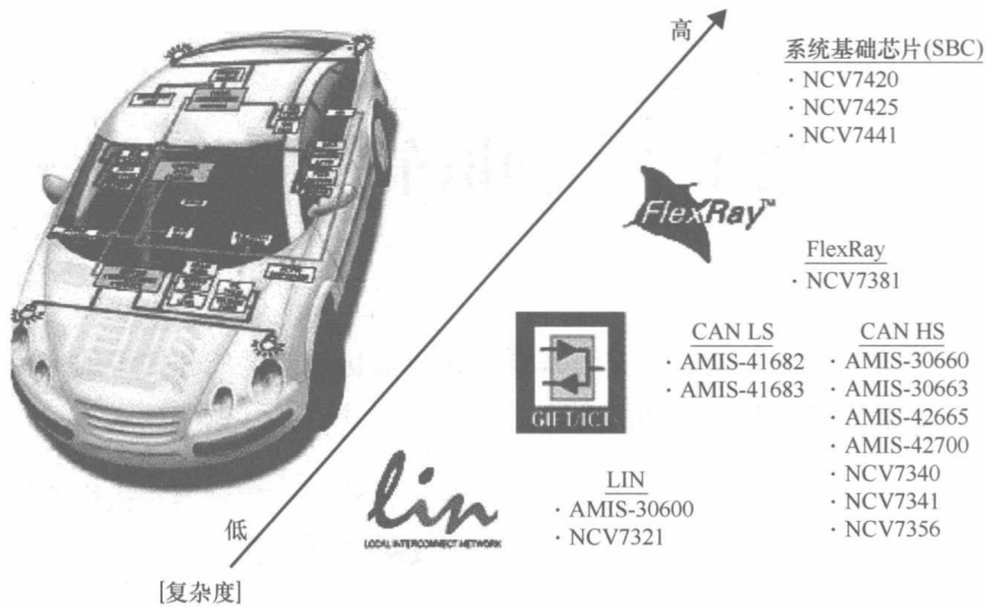
图 1.1 通用车载网络的结构分类图
