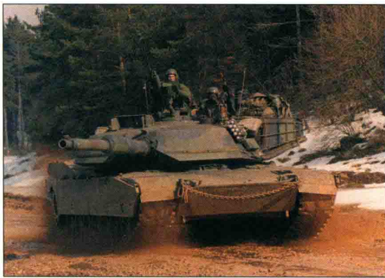
▲ 防护。M1A1艾布拉姆斯主战坦克的车身和炮塔配有先进的厚板“乔巴姆”复合装甲,可以在战场上有效抵挡反坦克导弹和其他武器的打击。
