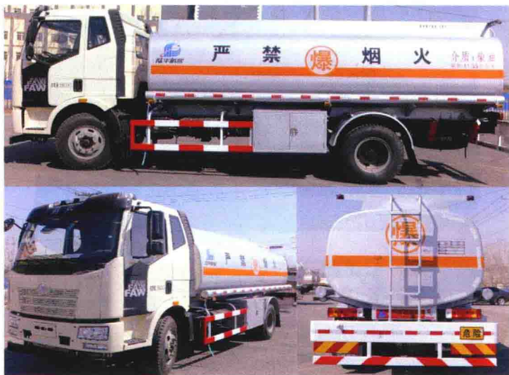
图 1-2 运输易燃液体的整体式罐车
