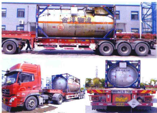
图 1-5 运输剧毒液体的罐式集装箱半挂车
