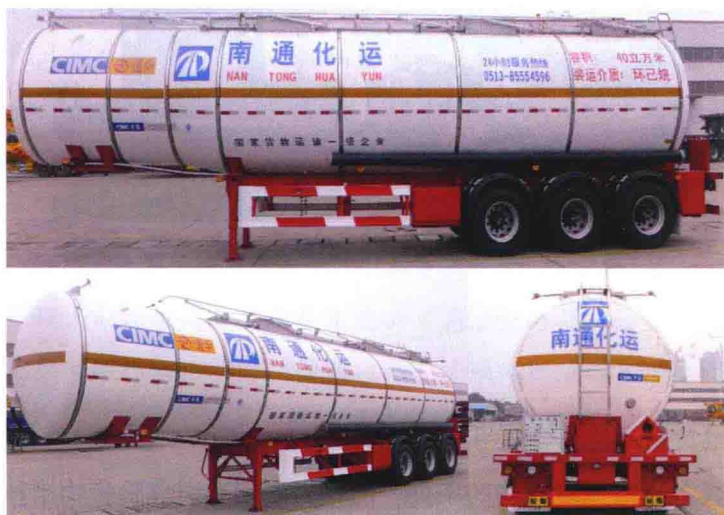
图 1-3 运输易燃液体的罐式半挂车
