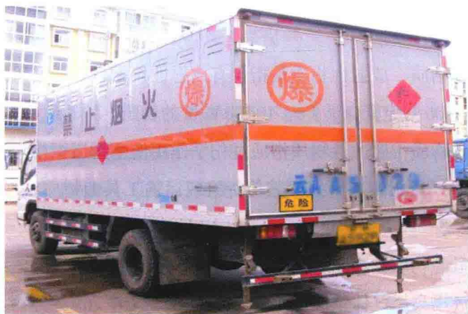
图1-1 运输爆炸品的厢式车辆
