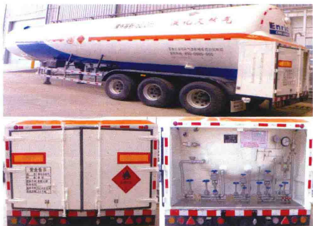
图 1-4 运输液化气体的罐式半挂车
