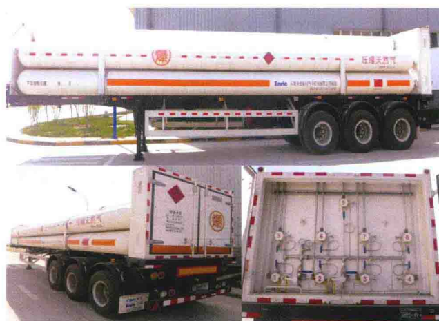
图 1-7 高压气体长管拖车
