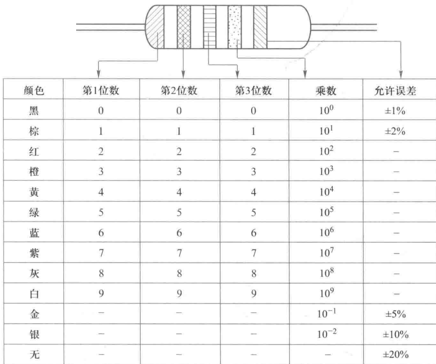
图 2-4 五色环电阻值的表示方法
