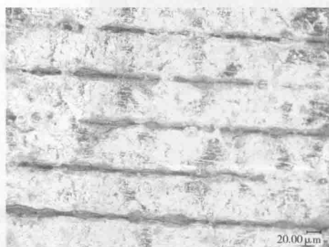
图 24 电解蚀刻时间为 8min
