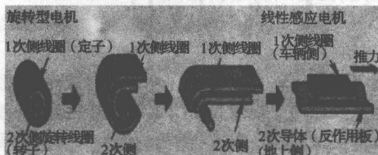
图10 从旋转电机向直线电机的展开示意图
