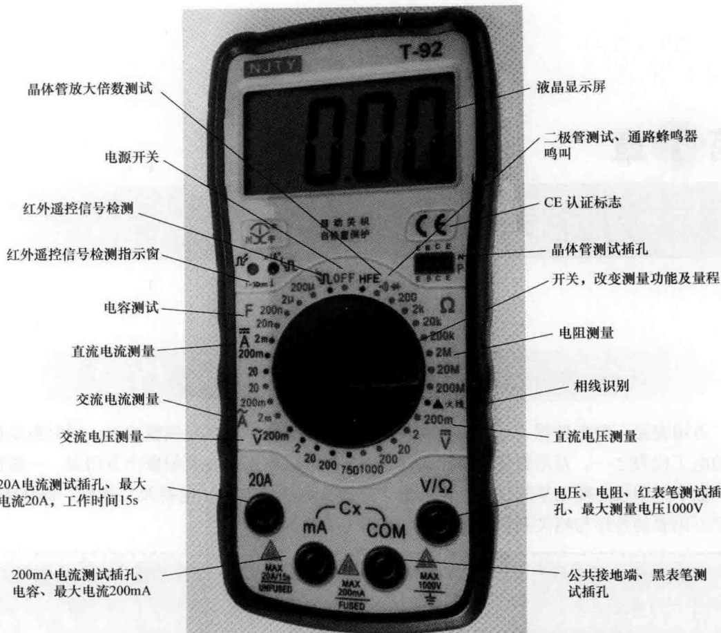
图 1-1 数字万用表的外形与相关测量功能简介 (续)
