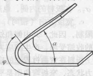
图1-5 弯曲角与弯曲带中心角
