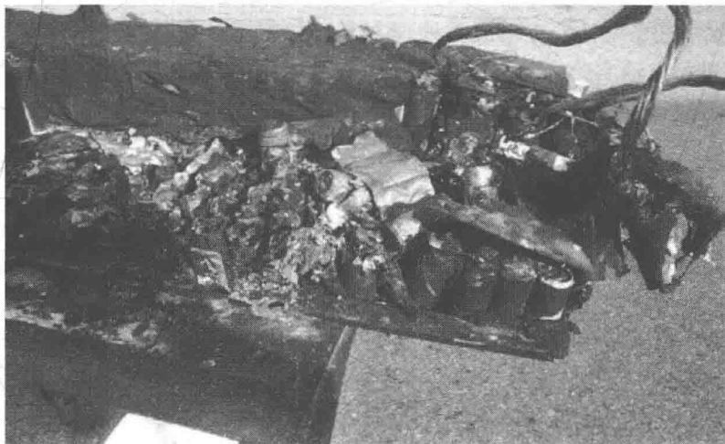
图 1.4 灭火后的图 1.3 中的电池
