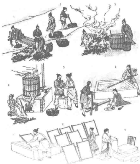
东汉造纸流程图
