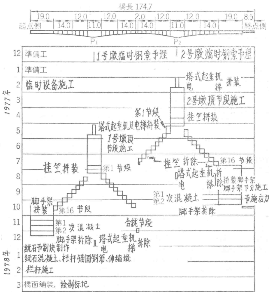
图 8 上部结构施工进度安排表
