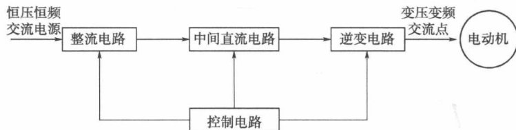
图 1-28 交—直—交变频器的基本构成框图
