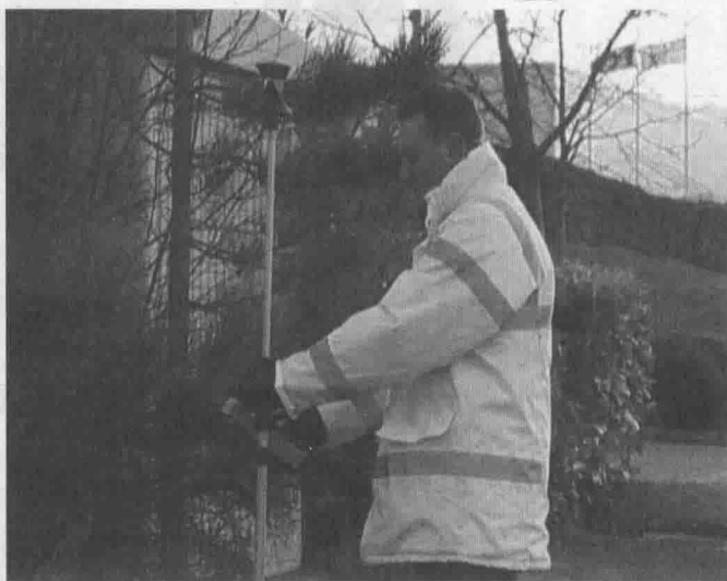
图 1.2 利用徕卡 TPS1200 系列全站仪进行镜站遥控电子平板测图 2
