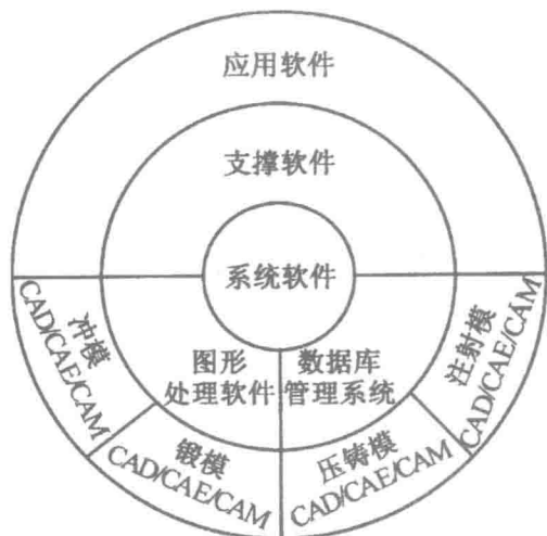
图 1-4 模具 CAD/CAE/CAM 系统软件层次图
