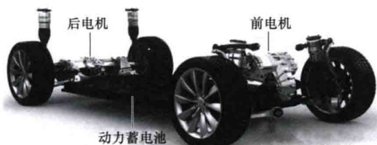
图 1-12 特斯拉底盘上前后电机的布置
