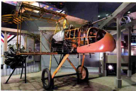
这架复制品展现了FE.8机身的内部构造
