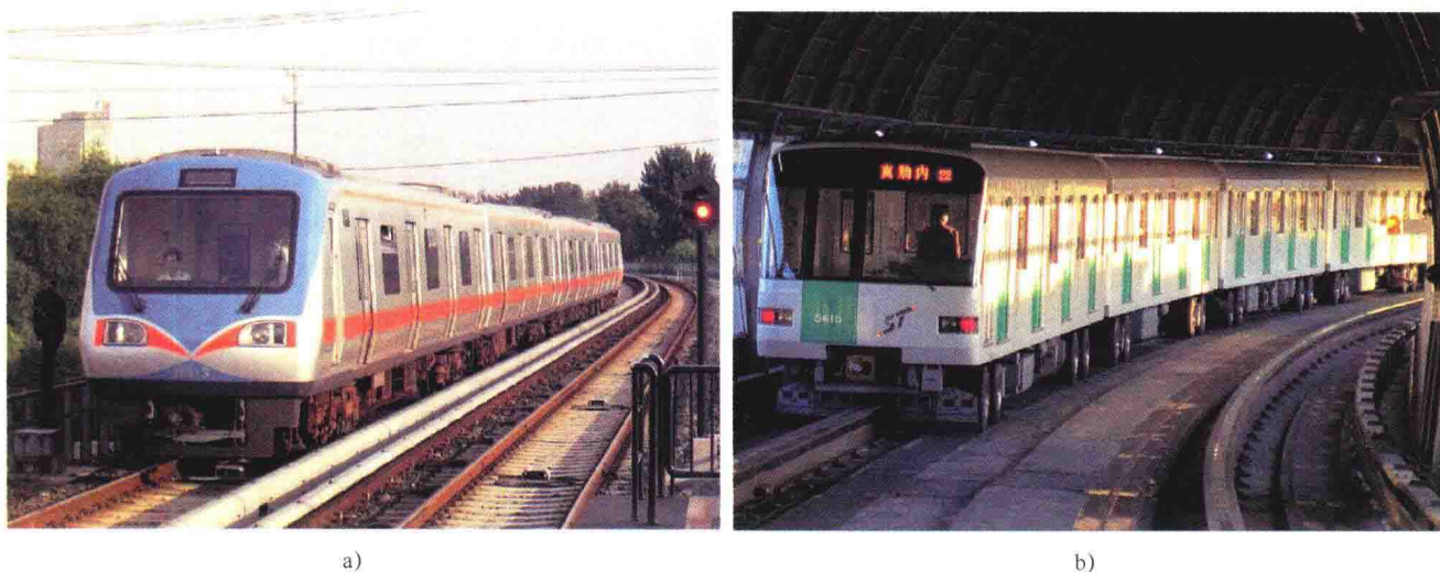
图 1-5 按支承导向制式划分类型 a) 钢轮双轨系统 b) 胶轮单轨系统
