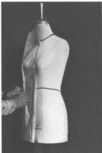
⑦ 用剪刀剪掉多余部分，沿人台侧缝折出侧缝线，注意线要垂直地面。
