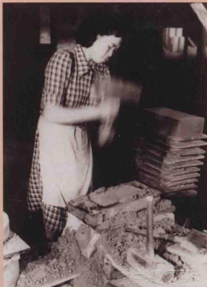
圖8：北投陶耐廠女工以木模製作耐火磚的舊照。臺灣工礦公司提供。
