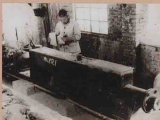
圖6：北投陶耐廠的練土機舊照，臺灣工礦公司提供。
