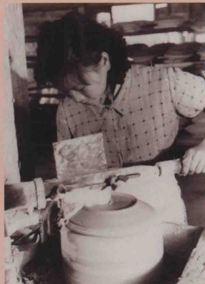
圖11：覆銼壓法製作盤子舊照，臺灣工礦公司 提供。
