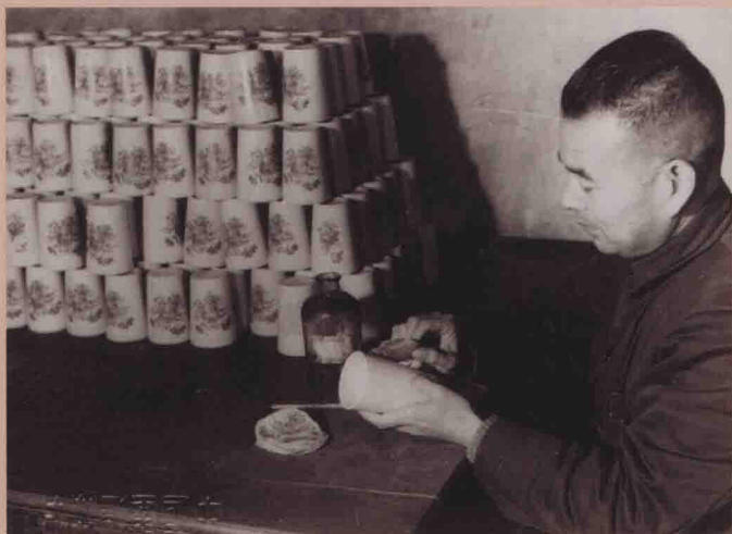
圖20：臺灣工礦公司北投陶瓷廠員工在高杯上貼轉寫花紙的舊照，臺灣工礦公司提供。
